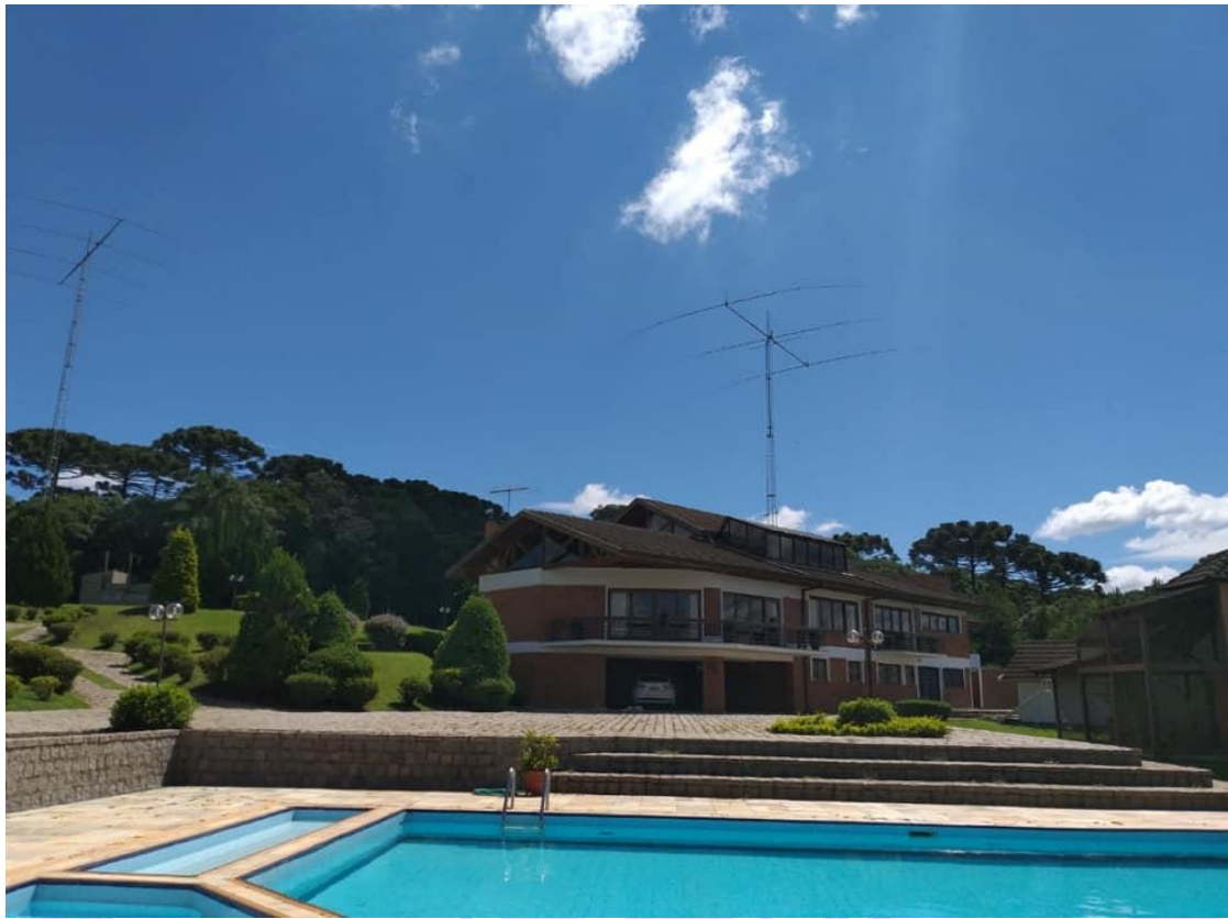
Imagem: Linda vista das 2 antenas em tamanho full size, à esquerda 4 elementos para a faixa de 40 m e à direita 3 elementos para a faixa de 80 m
